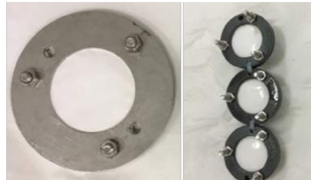
POCIS ( Polar Organic Chemical Integrative Samplers ) : échantillonneurs passifs pour mettre en évidence la présence de polluants dans les eaux
