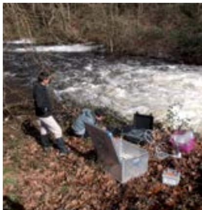
Mesure de la pression partielle de CO<sub>2</sub>
